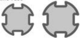
Estrusione ØM 70 mm Estrusione ØL 83 mm
