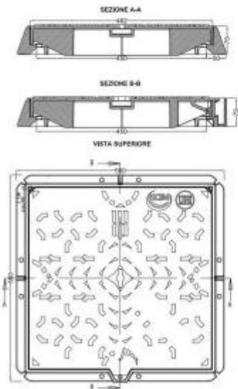
**Quadratische Schachtabdeckung aus sphäroidischem Gusseisen h638\_123**
