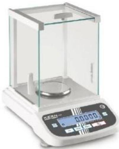
**Analysenwaage für Laborwägungen
